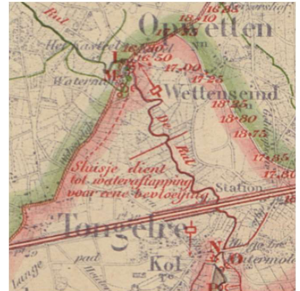
Uitsnede Waterstaatskaart 51-4, ca 1877 – traject Kol – Opwetten met aanduiding van het "sluisje ... voor eene bevoeiing"
